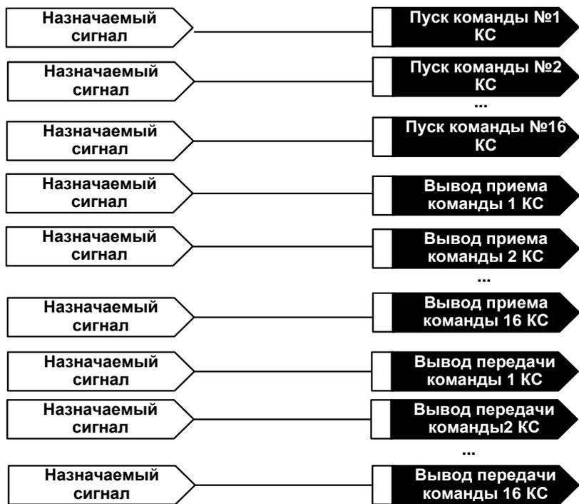
Рисунок 36 – Конфигурирование пуска, вывода приема и вывода передачи команд по КС
