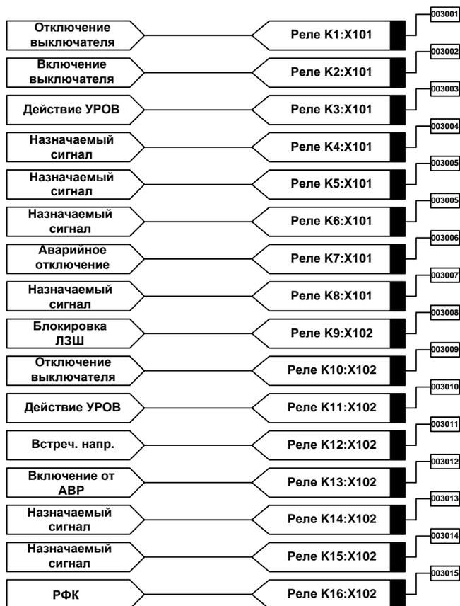
Рисунок 30 – Конфигурируемые реле
